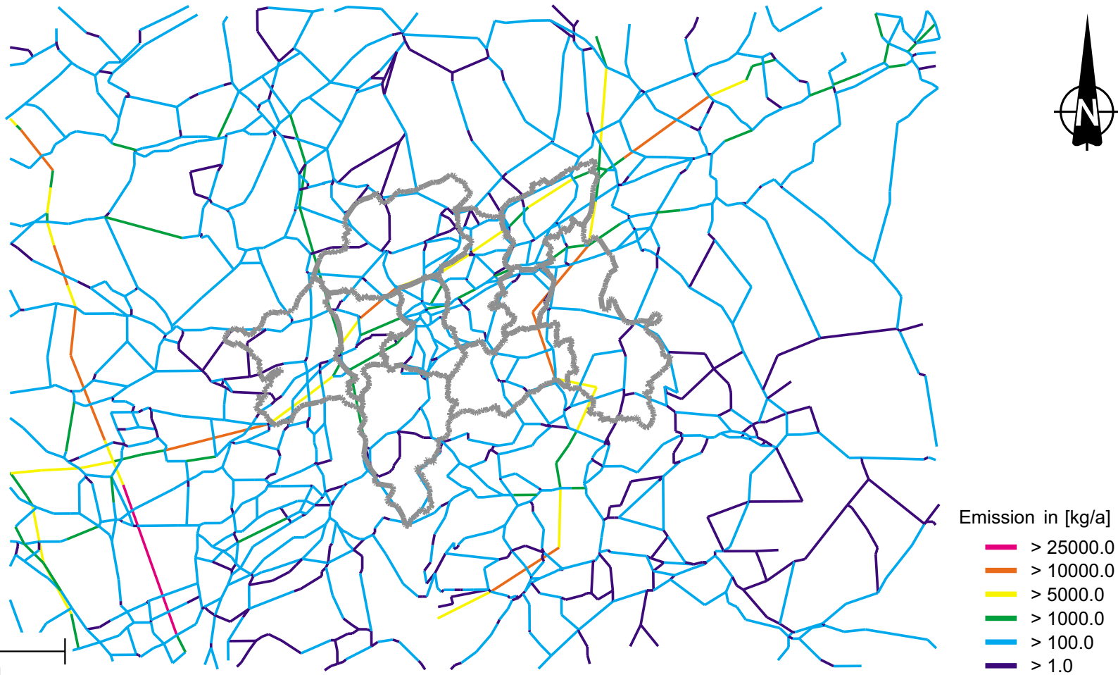
Abb. A4.9: SO 2 -Emissionen des Kfz-Verkehrs auf den Hauptverkehrsstraßen. Dargestellt sind die Emissionen für jeden Streckenabschnitt in Kilogramm pro Jahr [kg/a]. Die Stadt- und Stadtteilgrenzen von Wuppertal sind grau eingezeichnet.
