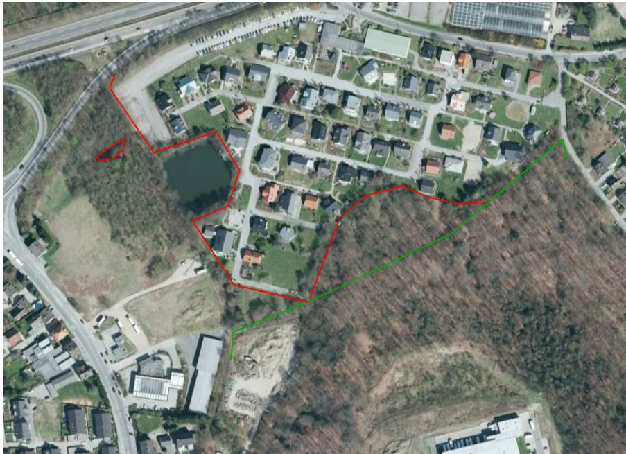
Abbildung 7: Übersicht der Amphibienleitanlagen. (rot = temporär, grün = dauerhaft). Darstellung schematisch und nicht maßstabsgetreu.
