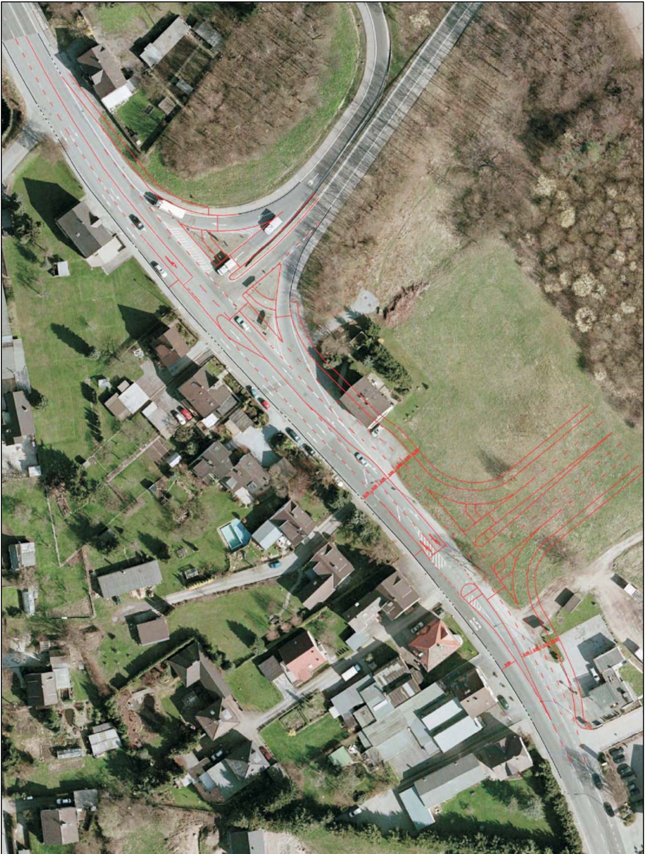
Abbildung 5: Lageplan zur Umgestaltung des Knotenpunktes 3 & Neuanlage des Knotenpunktes 4; Quelle: INGENIEURBÜRO FÜR VERKEHRSWESEN KOEHLER & LEUTWEIN (08/2012)
