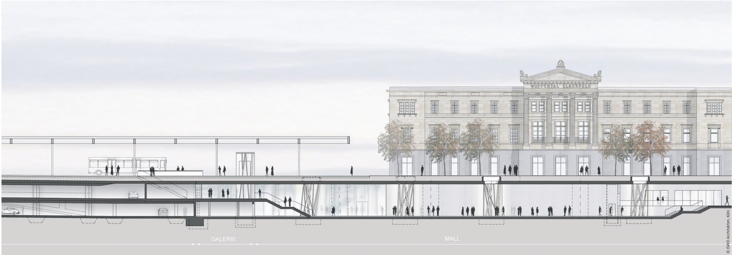
Die Ebenen des Döppersbergs im Querschnitt: Die Mall ist über den unteren Platz ebenerdig zu erreichen. Der obere Platz bindet barrierefrei die Bus- und Bahnsteige an.
