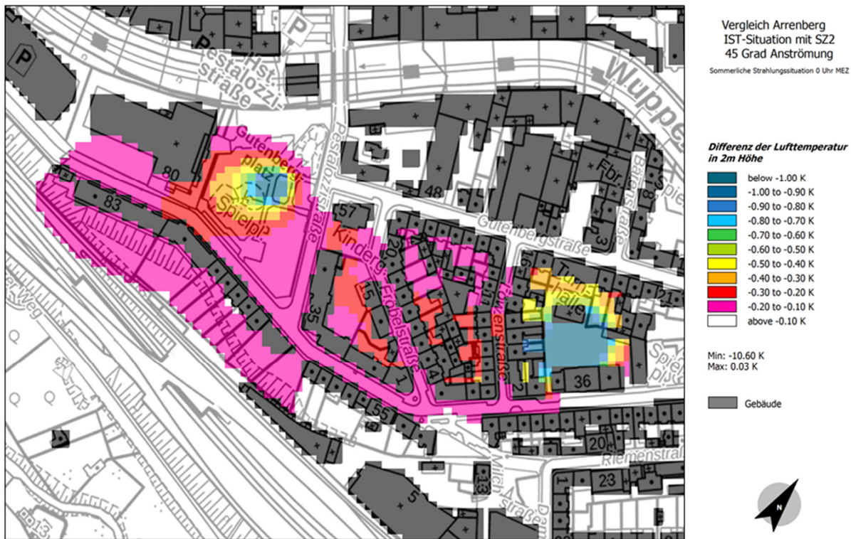
Abb. 4.21a Differenzen der Lufttemperaturen in 2 m Höhe um 0 Uhr im Modellgebiet Arrenberg, Teil Gutenbergplatz, Szenario 2 minus IST-Situation, Anströmung aus Nordost
