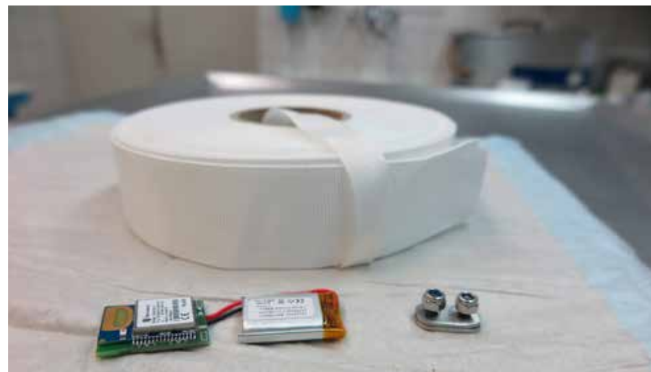
Der Sender ist in einem Schlauch eingekapselt, welches dem Tier als Halsband umgelegt wird. So wird das Verletzungsrisiko minimiert. Foto: Der Grüne Zoo Wuppertal
